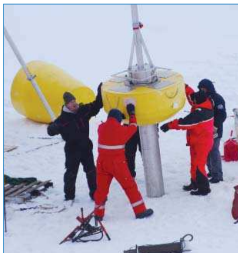
Установка на лед дрейфующих автономных измерительных комплексов.
