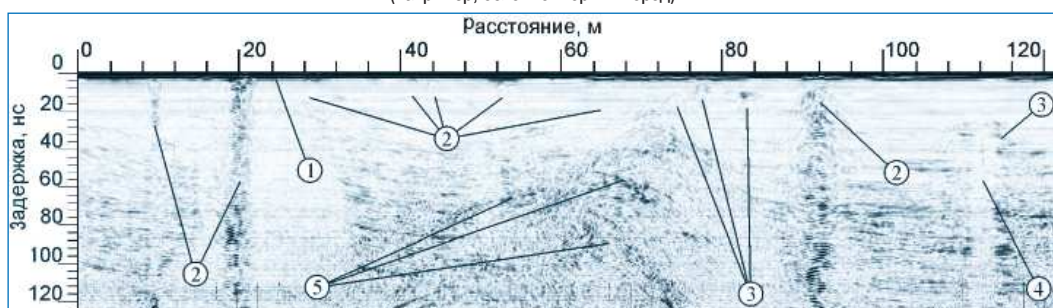
Пример типичного временного георадарного разреза, выполненного при лоцировании зон трещин в ледовом массиве: 1 – нулевая отметка (поверхность ледника); 2 – отражения от стенок приповерхностных трещин; 3 – отражения от стенок широких трещин, перекрытых относительно мощными снежными мостами; 4 – отражения, характеризующиеся значимым ослаблением сигнала, связанные с затуханием волн в трещине; 5 – отражения, связанные с инородными включениями (например, обломков горных пород).
