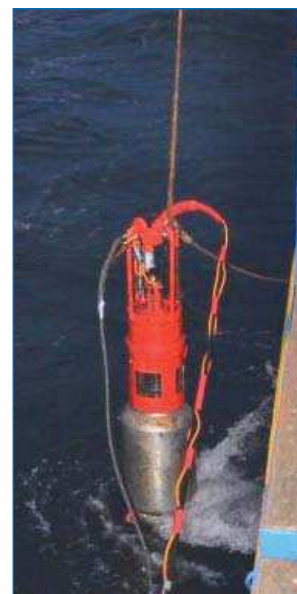
Сброс донной сейсмической станции самовсплывающего типа (слева) и пневмоисточник типа СИН-6М (справа) (разработка ОАО «Севморгео»). Фото Н.Е. Леоновой.
