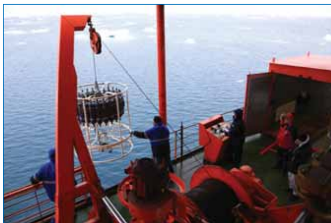
Работа зондирующим комплексом «Sea Bird 911+» в заливе Прюдс. Фото А.И. Нагаева.
