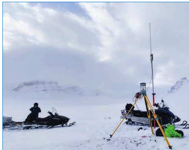
Установка базовой станции SOKKIA на морене ледника Альдеганда. Фото А.Л. Борисик
