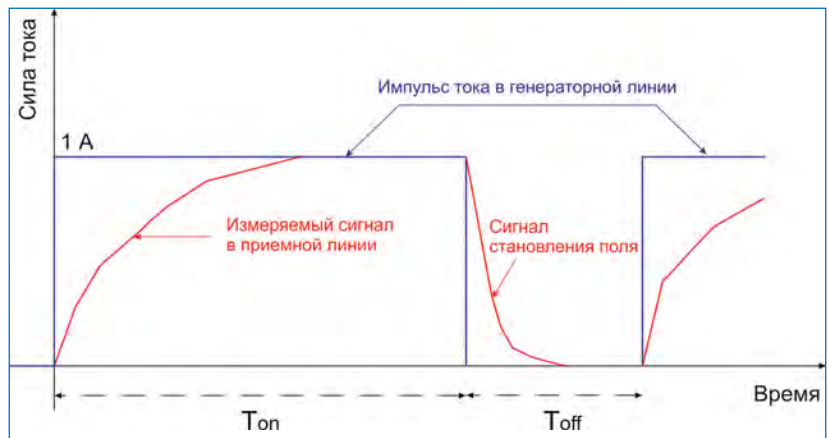
Рис. 2. Импульс тока и измеряемый сигнал при работе методом ЗСБ
