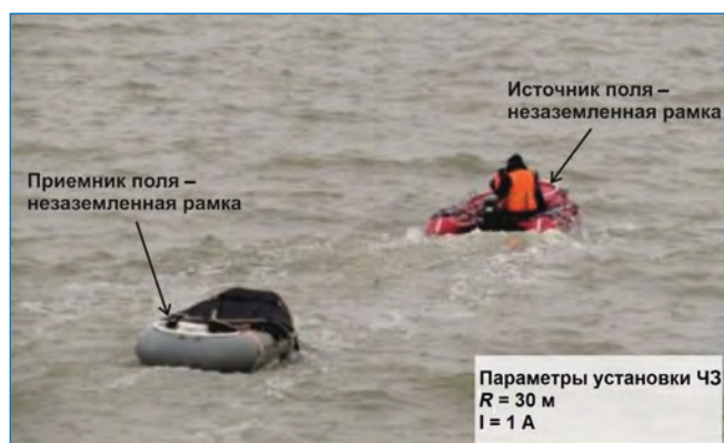
Рис. 5. Морские геофизические работы методом ЧЗ на Приамальском шельфе
