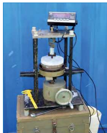
Испытания изгибной прочности льда на малых образцах
