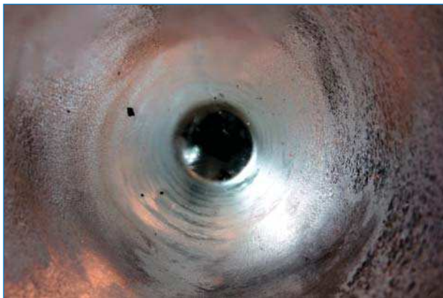
Включения донных осадков озера Восток в керне озерного льда, поднятом с глубины 3607 м из скважины 5Г-3. Снимок сделан со стороны предварительно отполированного торца керна.
