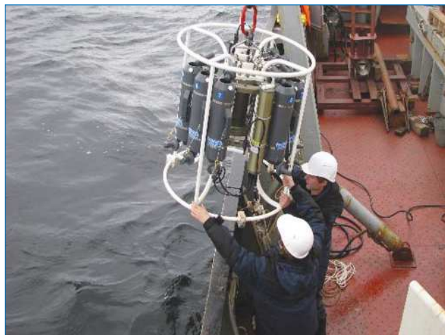
Постановка донной океанографической станции в море Лаптевых на годовой срок наблюдений (слева) и подготовка зонд-батометра к CTD-измерениям и отбору проб воды пластиковыми батометрами (справа).
