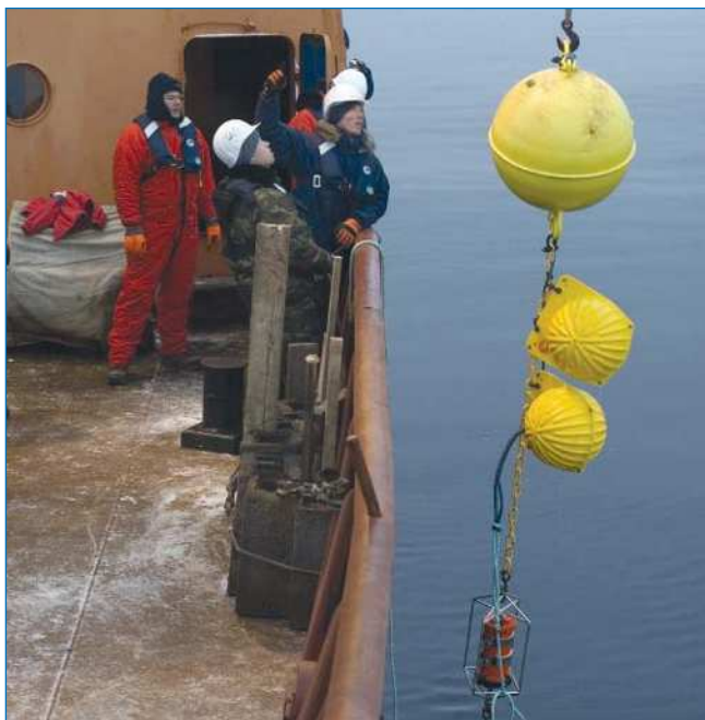
Постановка донной океанографической станции в море Лаптевых на годовой срок наблюдений (слева) и подготовка зонд-батометра к CTD-измерениям и отбору проб воды пластиковыми батометрами (справа).
