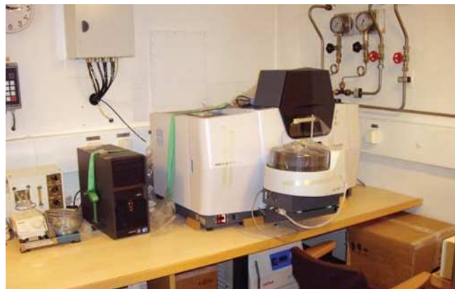
Солемер Autosol 8400 (слева), атомноабсорбционный спектрометр AA-7000 (справа).
