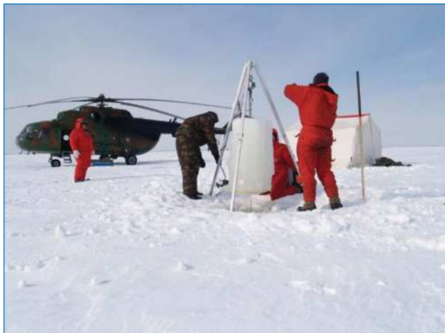
Экспедиция «ПОЛЫНЬЯ-2008/TRANSDRIFT-XIII» на припайе зимой 2008 г. Извлечение ледового керна.
