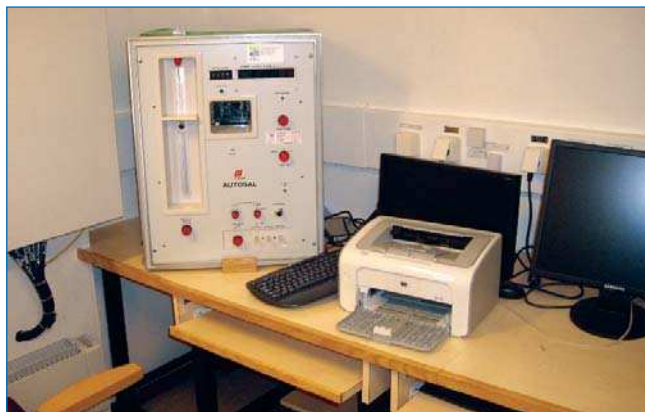
Солемер Autosol 8400 (слева), атомноабсорбционный спектрометр AA-7000 (справа).
