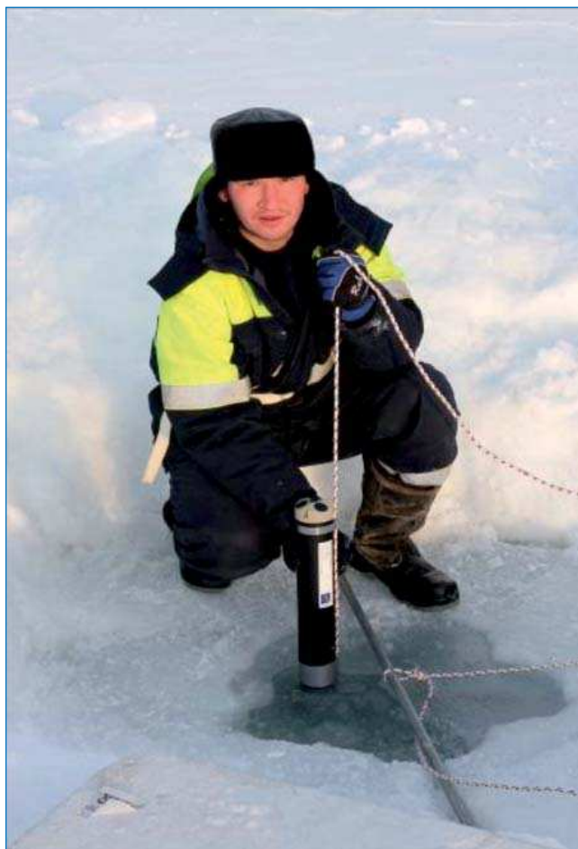
Сотрудником ААНИИ А.А.Балакин устанавливает ADCP Nortek Aquadopp Pro.
