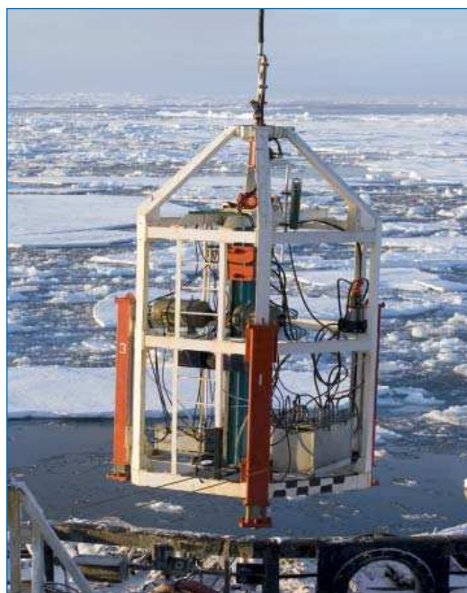
Донный буровой станок ГБУ-2 (ОАО «Севморгео») при выведении его за корму ледокола для опускания на дно (красные штанги – выдвижные «ноги» системы горизонтирования).
