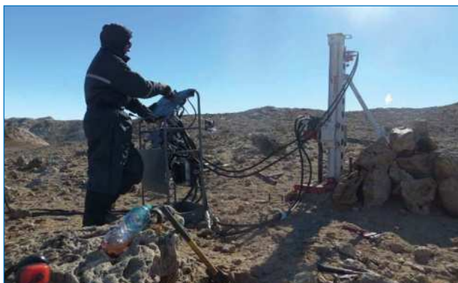
Буровая установка МГБУ «Термит» в оазисе Холмы Ларсемана.
