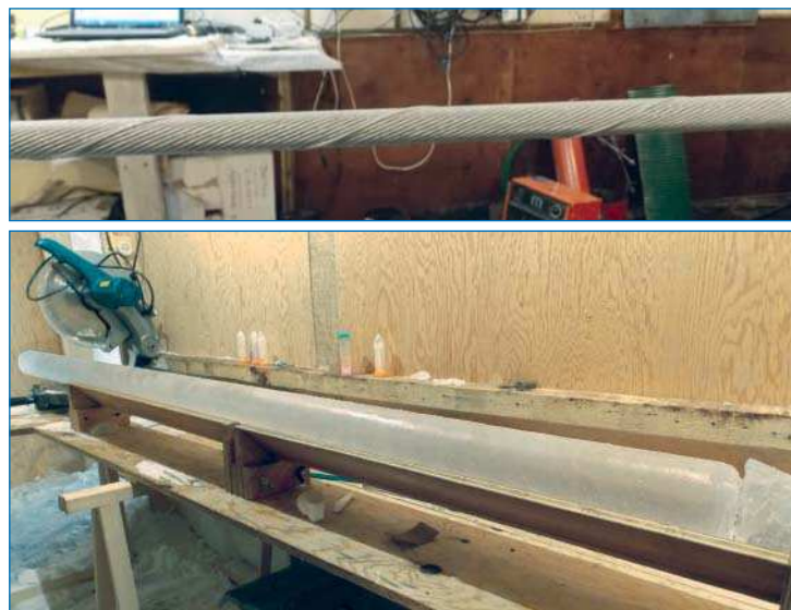
Повреждения грузонесущего кабеля (верхний снимок) и образец извлеченного керна (нижний снимок).
