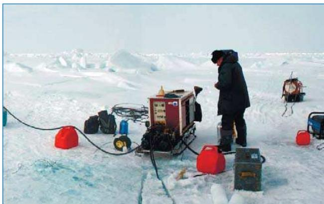
Установка УВБЛ-2 для водяного термобурения.
