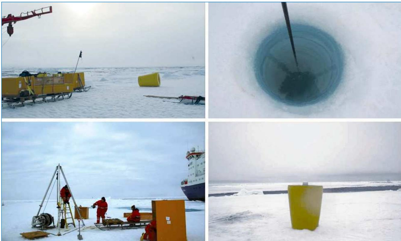
Установка на лед станции нового поколения типа ITR, позволяющей отслеживать физические параметры воды в постоянном режиме. Фото Дж.П.Мейера (J.P. Meyer).
