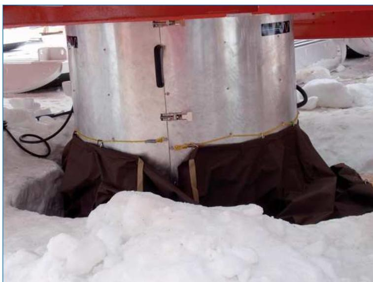
Система очистки шланга перед погружением. Слева – манжета с водой и воздухом, справа – УФ-хомуט.
