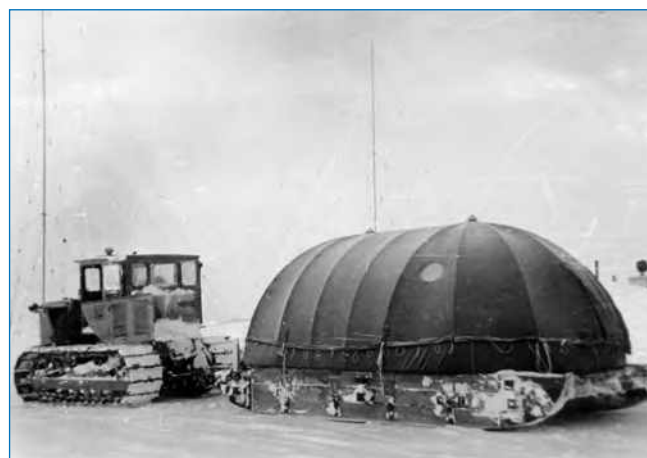
Перевозка палатки КАПШ-2, в которой будет оборудована аварийная база, в глубь шельфового ледника
