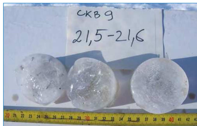
Керны из ледяного тела булгуньях в поперечном сечении. Видны единичные вкрапления темного глинистого материала
