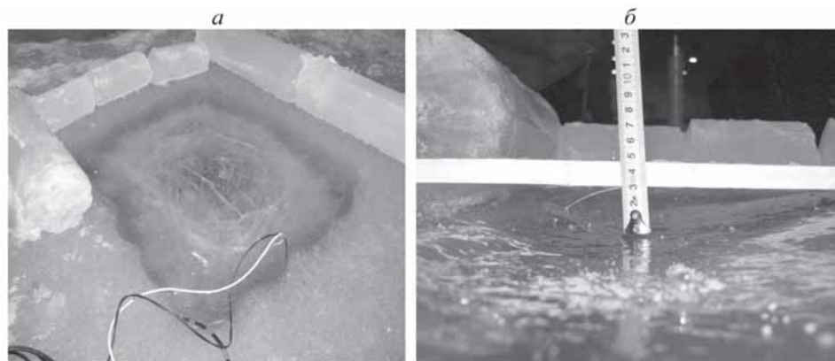
Рис. 11. Типы деформации льда на поверхности искусственной снежицы: а – трещины; б – «вздутия»
