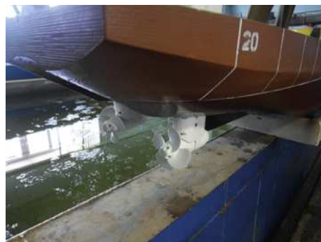
Рис. 4. Двигательный комплекс, установленный на модель НЭС «Иван Фролов»
