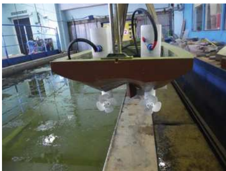
Рис. 4. Двигательный комплекс, установленный на модель НЭС «Иван Фролов»
