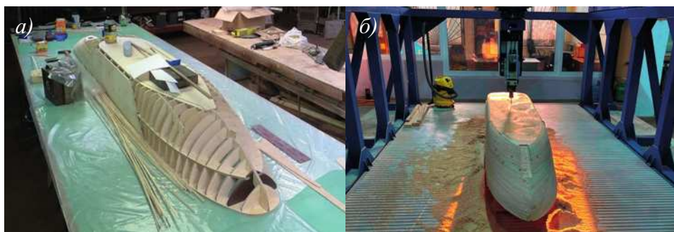
Рис. 11. Изготовление модели судна в ААНИИ: а — изготовление деревянной каркасной модели по традиционной технологии; б — изготовление модели на пятиосевом фрезерном станке Fig. 11. Making a ship model at AARI: a — manufacturing the wooden frame model according to traditional technology; b — cutting out the model on a five-axis milling machine
