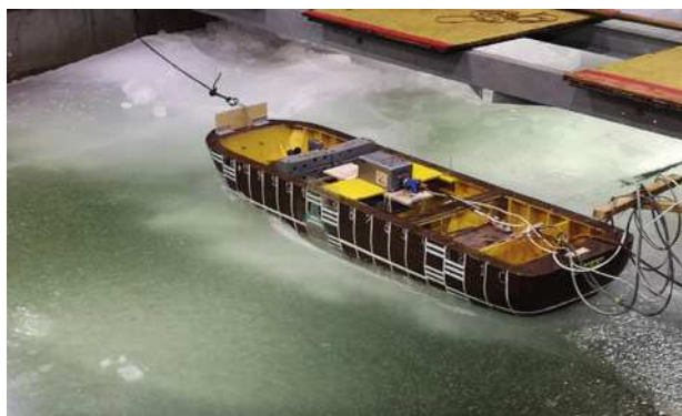
Рис. 5. Модель ЛСП (масштаб 1:40) во время проведения эксперимента по воздействию интенсивных ледовых сжатий на корпус
