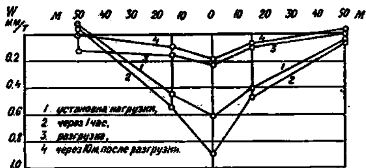
Рис. 5. Изменение величины относительного прогиба во времени W = w/Q , Q — вес нагрузки в тоннах [21, с. 48]
