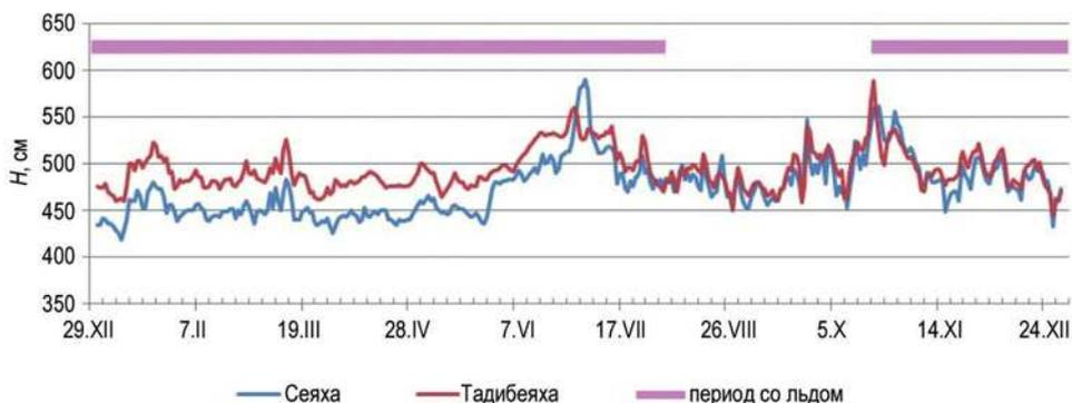
Рис. 5. Внутригодовая изменчивость среднесуточного уровня воды на постах Сеяха и Тадибеяха в 1987 г.
