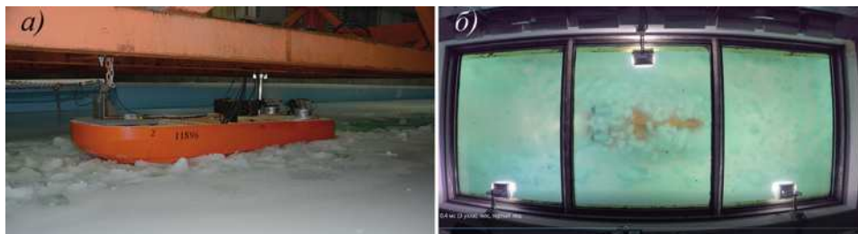
Рис. 2. Испытания модели буксира для порта Сабетта в канале с тертым льдом: а — вид сверху; б — взаимодействие подводной поверхности буксира с тертым льдом
