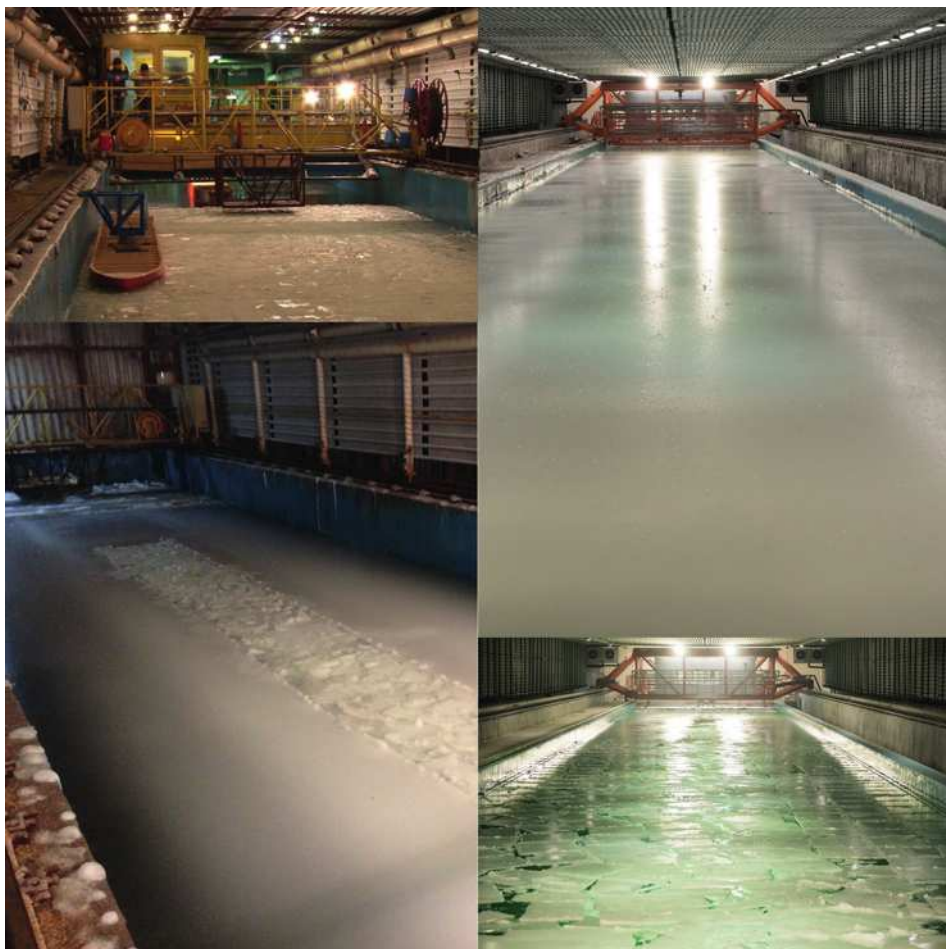
Рис. 1. Ледовые опытовые бассейны КГНЦ. Слева — ледовый бассейн, построенный в 1980 г.; справа — ледовый бассейн, построенный в 2014 г.
