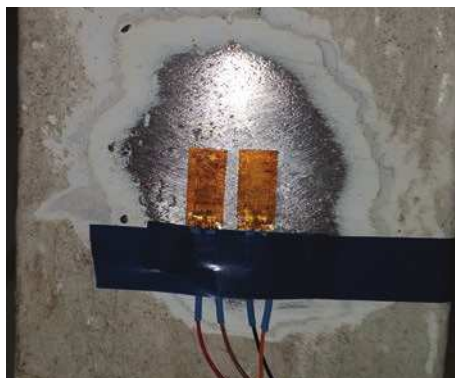
Рис. 5. Пример установки тензодатчика на шпангоуте
