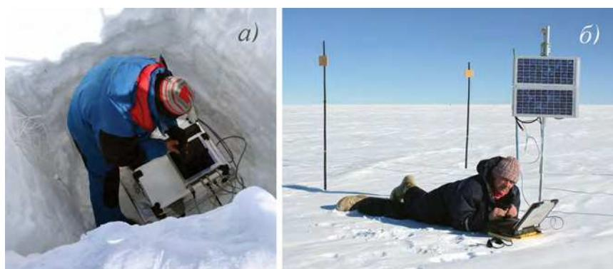
Рис. 1. Автономная система мониторинга температуры снежной толщи TAUTO:
