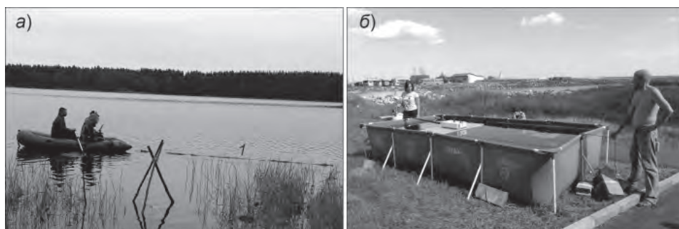
Рис. 1. Рабочие фотографии: а — геофизическая съемка с антенной АБДЛ «Тритон»; б — выполнение измерений в бассейне; 1 — антенна АБДЛ «Тритон».
