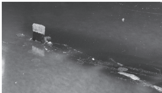
Рис. 7. Разрушение льда пером вертикального руля.
