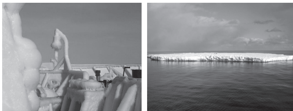
Рис. 2. Неблагоприятные гидрометеорологические угрозы приводят к обледенению палубных конструкций ледокола (слева — «Капитан Драницын» в Баренцевом море) и к неблагоприятной ледовой обстановке: справа — большой столообразный айсберг массой 3,7 млн т, обнаруженный экспедицией ААНИИ в мае 2003 г. в составе аномального скопления айсбергов в районе Штокмановского ГКМ. Фото из архива ААНИИ.
