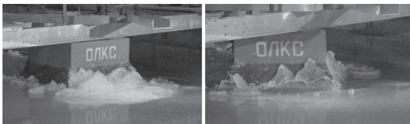
Рис. 7. Модель сооружения гравитационного погружного типа во время испытаний в ледовом бассейне при толщине моделированного льда 23 мм (что соответствует 1,4 м в натуральных условиях): воздействие льда на фронт сооружения (слева) и воздействие льда под углом 45° к фронту сооружения (справа).
