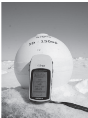
Рис. 4. Радиомаяк спутниковой системы ARGOS, установленный в припае.
