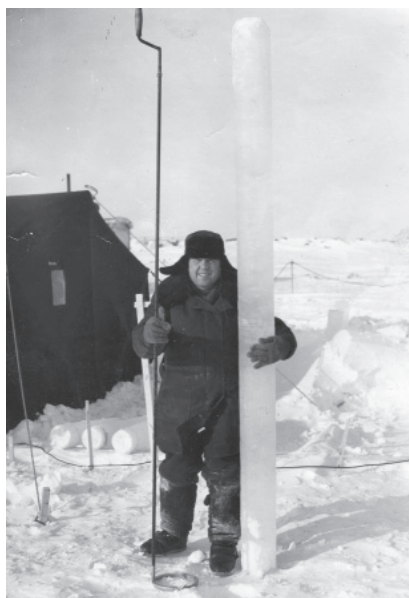
Н.В. Черепанов с кольцевым буром собственной конструкции и редким по длине ледяным керном, полученным при его использовании.
