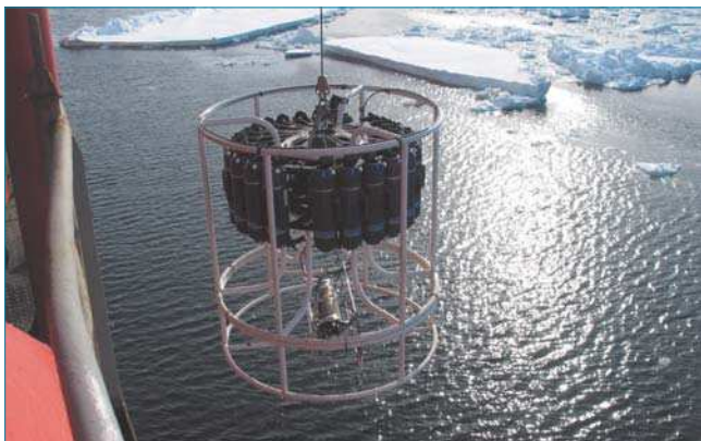
Океанографические исследования с борта судна при помощи зондирующего комплекса «SeaBird 911». Фото Н.Антипова
