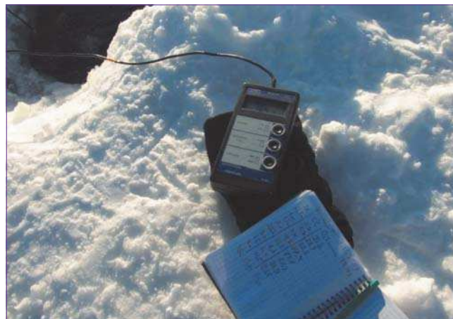
Рис. 3. Измерение содержания кислорода в оз. Китеж датчиком Марк-201
