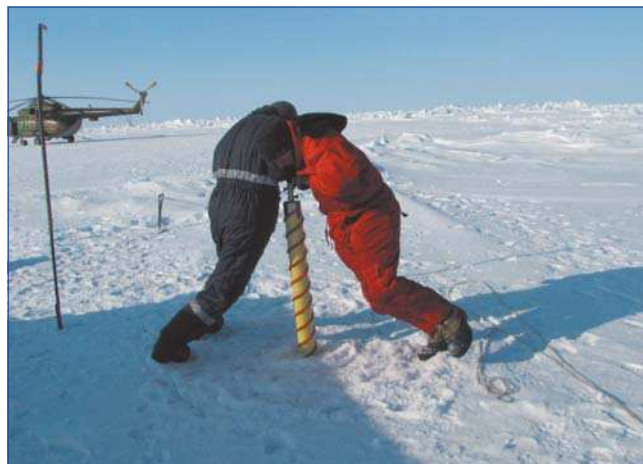
Выбуривание ледяного керна из припая моря Лаптевых. Фото предоставлено лабораторией им. О.Ю.Шмидта
