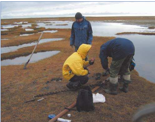
Бурение скважин для измерений температуры в заливаемой лаиде Карского моря
