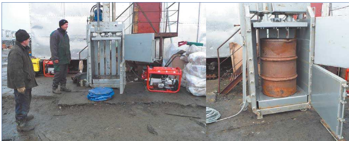
Работа прессы: слева – бочка современного производства сплющена и лежит перед прессом, справа – видимых изменений с бочкой старой конструкции не произошло (вмятина сверху была раньше)
