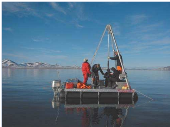
Бурение мерзлотной скважины на акватории оз. Эльгыгытгын. Фото Г.Штофа (АВИ)
