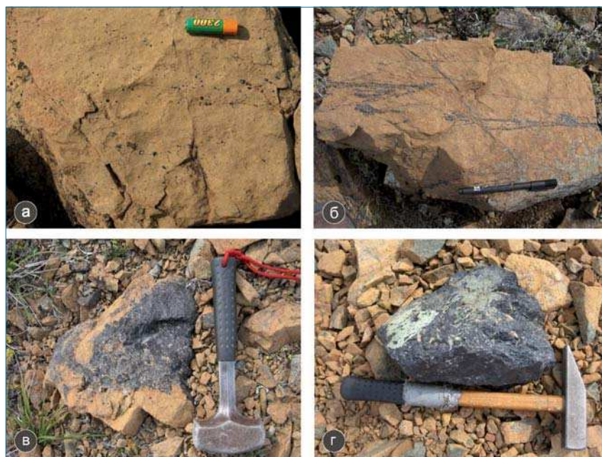
Рис. 3. Типы хромитовой минерализации в дунитах, связанных постепенными переходами с шпинелевыми гарцбургитами: (а) рассеянно-вкрапленные, (б) струйчатые, (в) орбикулярные и (г) массивные выделения хромитов
