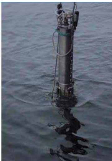
Измеритель гидрологических параметров модифицированный АЦИТ-М
