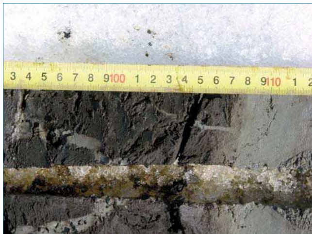
Рис. 2. Тектоническое нарушение в донных осадках озера, расположенного на отметках 87 м над уровнем моря, в районе Кандалакши
