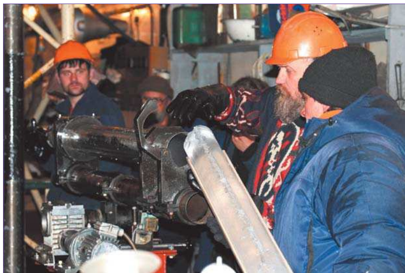
Буровые работы в скважине 5Г продолжались в зимовочный период 52-й РАЭ. Текущая глубина скважины – 3668 м
