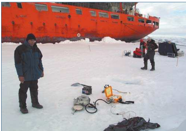
Измерение потоков \text{CO}_2 газоанализатором LI 8100. Фото П.Гребенникова
