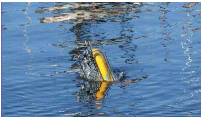
Подводный дистанционно управляемый аппарат Benthos Stingray во время работы. Фото Р.Вербицкого
