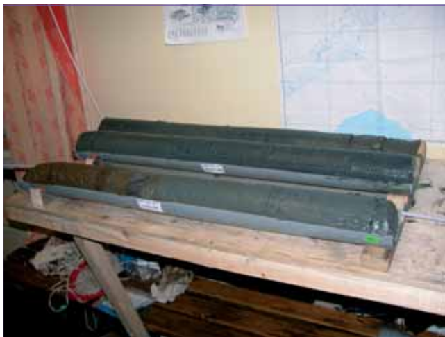
Образцы донного грунта, полученные при помощи грунтовой трубки
