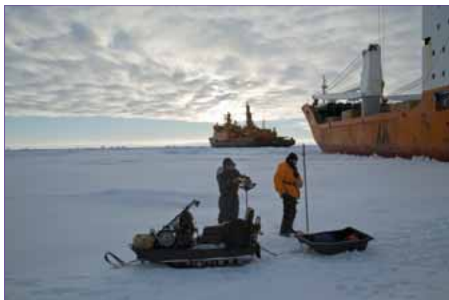
Измерение толщины льда в месте разгрузки судна
