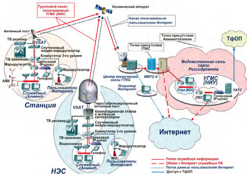
Рис. П.2.1. Схема подключения удаленных объектов к ресурсам и коммуникациям локальных сетей УГМС (НИУ).
