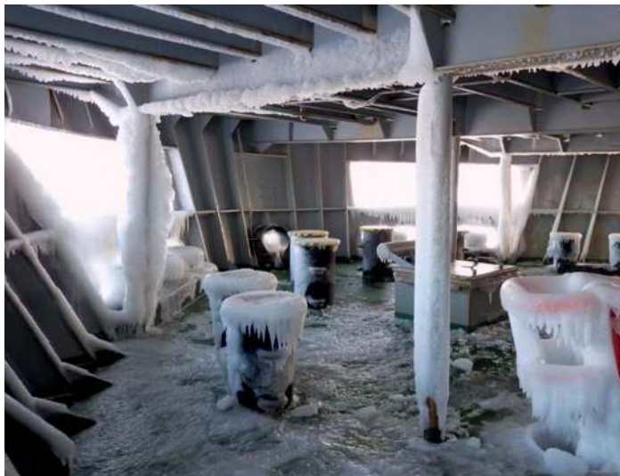
Рис. 1. Обледенение носовой части судна НЭС «Академик Федоров» на переходе Молодежная — Мирный 25—26 марта 2018 г. (фото В.А. Комаровского).
