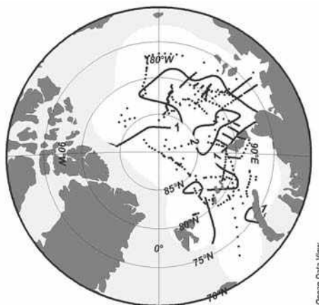
Рис. 3.13. Пространственное распределения классов зигзагообразных структур: до изолинии 1 — класс 1 (флуктуации температуры до 0,15^{\circ}\text{C} ), от изолинии 1 до изолинии 2 — класс 2 (флуктуациями температуры 0,15\text{--}0,25^{\circ}\text{C} ), внутри замкнутой изолинии 2 — класс 3 (флуктуации температуры более 0,25^{\circ}\text{C} )
