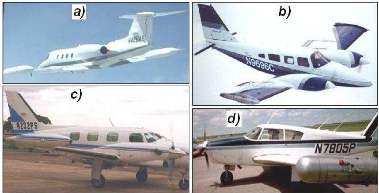
Рис. 13.2 – Самолеты, применяемые для авиационного засева облаков: а) турбореактивный самолет «LearJet»; б) турбинный самолет «Cessna 340»; в) турбинный самолет «Cheyenne-II»; г) турбинный самолет «Cessna-II»
