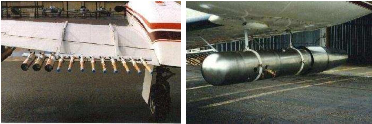
а) пиротехнический генератор; б) ацетоновый генератор
