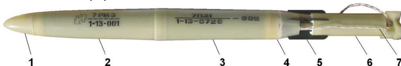
Рис. 13.16 – Малогабаритное ПГИ «Ас»: 1 – обтекатель; 2 – передняя часть корпуса; 3 – задняя часть корпуса; 4 – сопловый блок; 5 – складывающееся в калибр оперение стабилизатора; 6 – газогенераторный стартовый ускоритель; 7 – провода для подключения к ПУ
