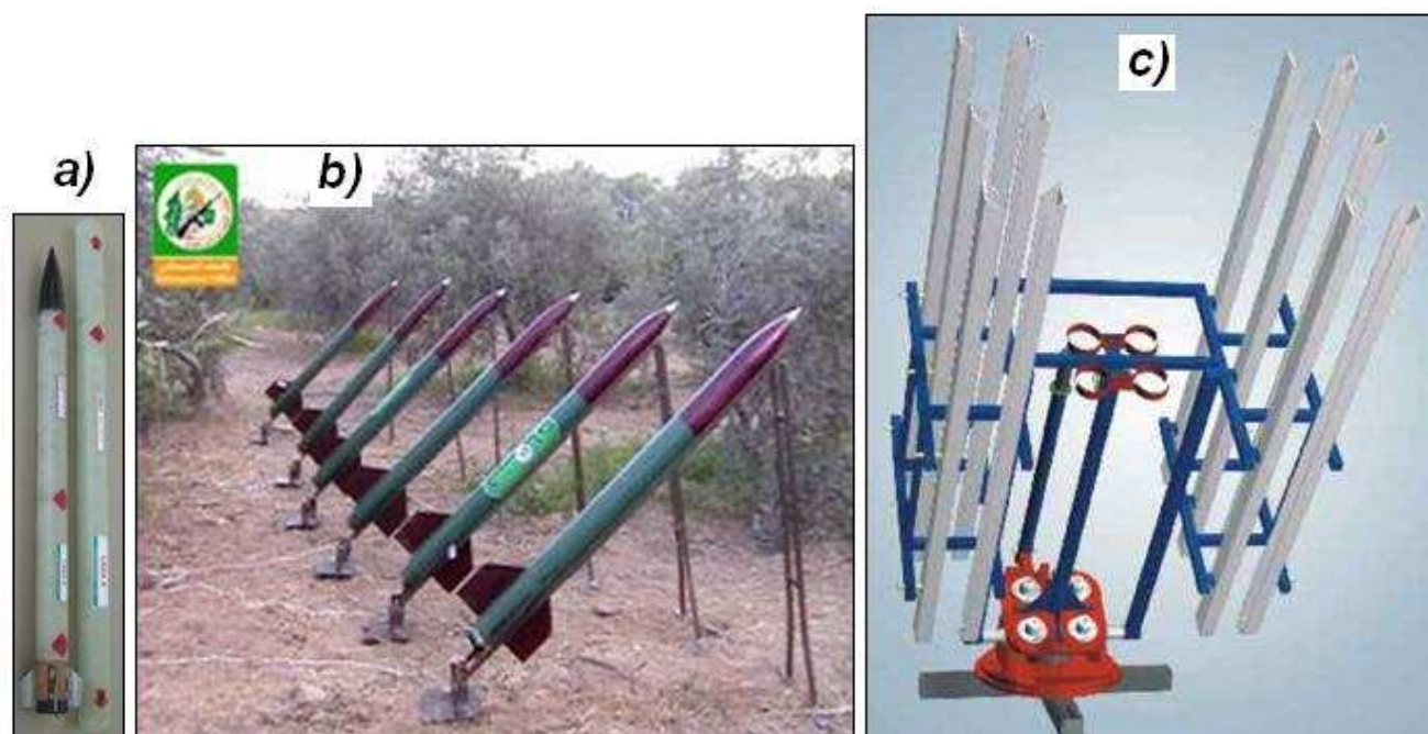
Рис. 13.10 – Болгарские ПГИ «Loza-6» с пусковым контейнером (а), ПГИ «Lazur» (b) и комбинированная ракетная установка для пуска этих ПГИ (с)
