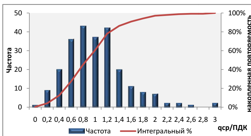
Рисунок 2.19 — Частота и накопленная повторяемость, %, среднегодовых концентраций ( q_{\text{ср}} ) диоксида азота в городах России
