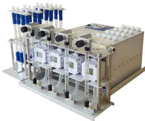
Рис 4.1 Штатив комбинированный 6-ти канальный
