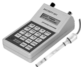
Рис. 5.10. Внешний вид измерительного преобразователя (вид сверху)
