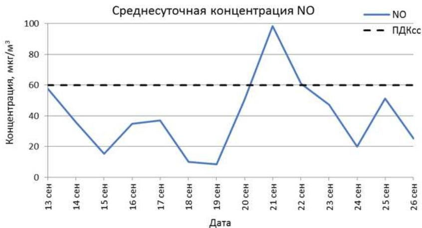
Рис. 10. График среднесуточной концентрации NO за две недели и среднесуточная ПДК<sub>сс</sub> NO
