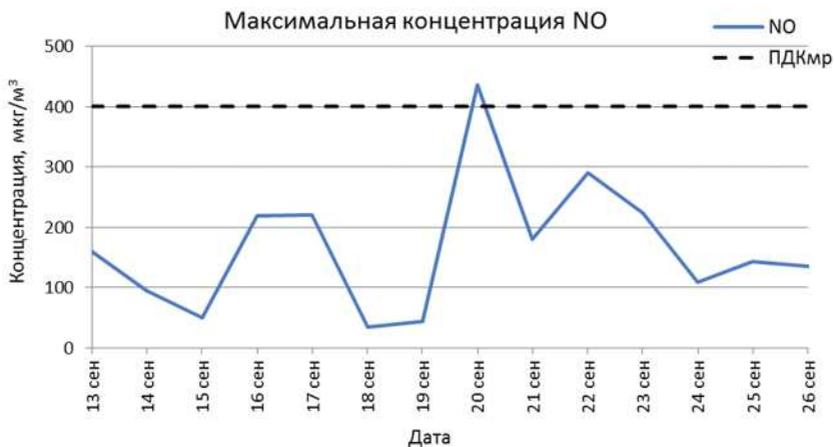
Рис. 11. График максимальной концентрации NO за две недели и максимально-разовая ПДК<sub>мр</sub> NO
