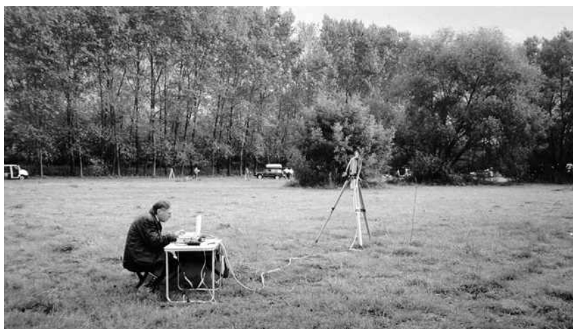
РИСУНОК Г1 ТИПИЧНЫЙ ПОЛЕВОЙ УЧАСТОК ДЛЯ ПРОВЕДЕНИЯ ГАММА-СПЕКТРОМЕТРИИ IN-SITU
