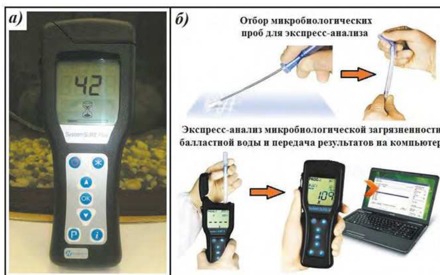
Рис. 9.17. Люминометр анализатора-люминометра Ultrasnap: а) общий вид прибора; б) последовательность стадий выполнения анализа
