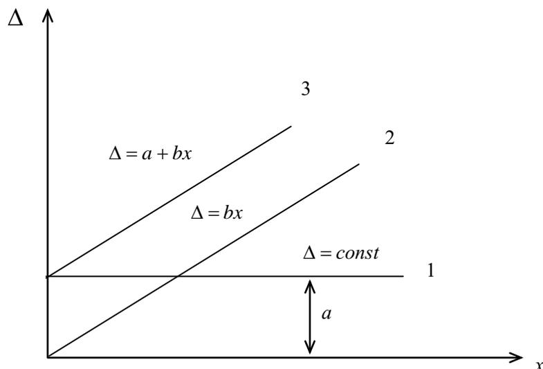
Рис. 1.8. Формирование аддитивной и мультипликативной составляющих погрешностей
