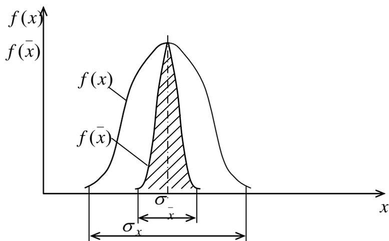
Рис. 1.5. Плотность распределения отдельного и суммарного результата измерения
