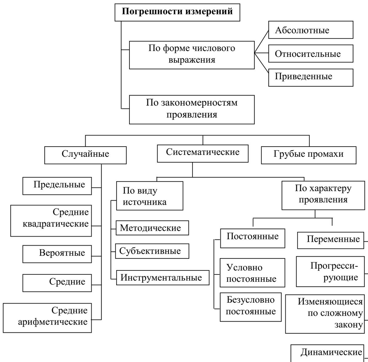
Рис. 1.4. Классификация погрешностей измерения
