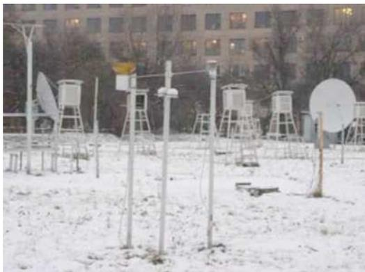
Рис. 2. АМС – автоматическая метеорологическая станция.
