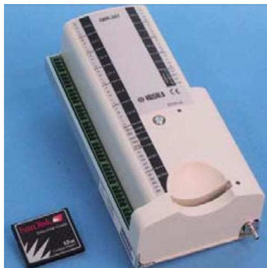
Рис. 10. Контроллер Vaisala QML201.
