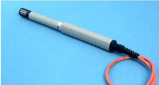
Рис. 4. Датчик температуры и влажности НМР45D.
