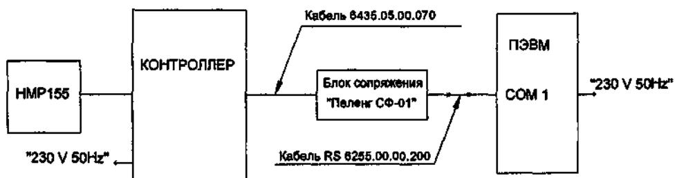
Рисунок Б.1- Схема подключения датчика HMP155.
