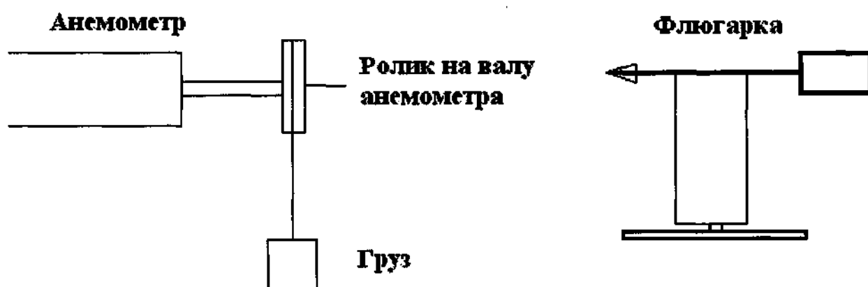
Рисунок 1 Схема определения моментов трения первичных измерительных преобразователей
