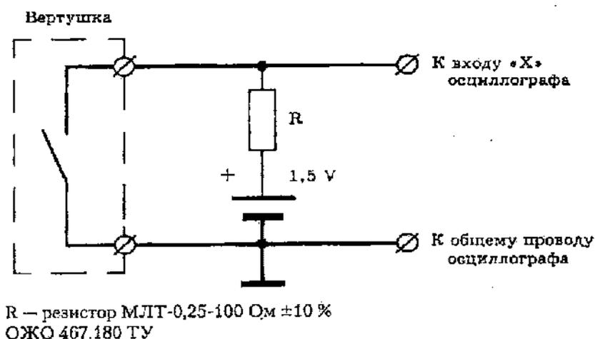
Рисунок 1 Схема подключения вертушки к осциллографу при опробовании.
