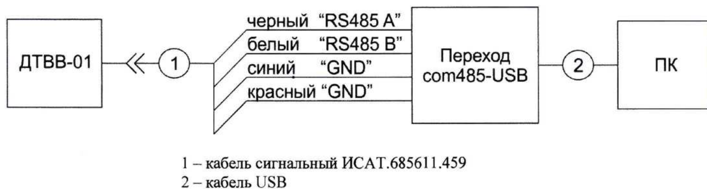
Рисунок А.1 – Схема подключения ДТВВ-01
