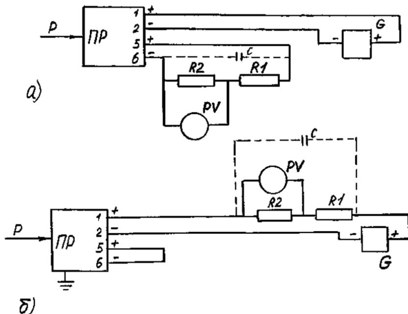
а) – подключение сопротивления нагрузки к клеммам 5 и 6.
