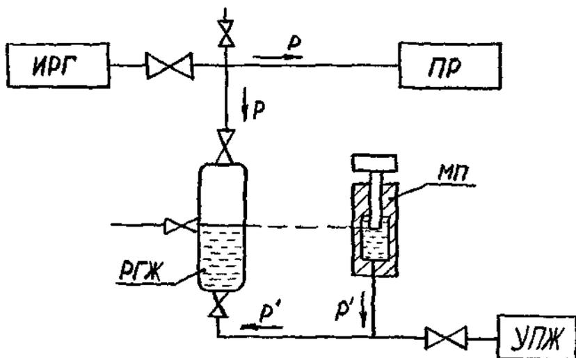
$P$  и  $P'$  - измеряемое давление и давление под поршнем МП (как правило  $P = P'$ );
