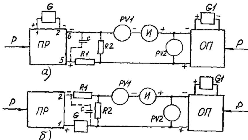
а) - подключение сопротивления нагрузки ( $R_1 + R_2$ ) к клеммам 5 и 6.
