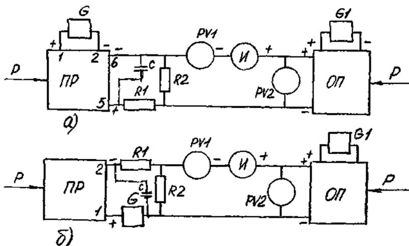
а) - подключение сопротивления нагрузки ( $R_1 + R_2$ ) к клеммам 5 и 6;
