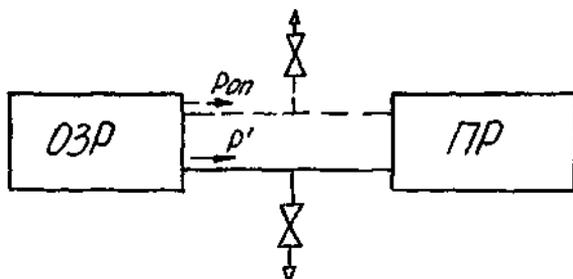
ОЗР - образцовый датчик давления и (или) разрежения (например, "Воздух-250");
