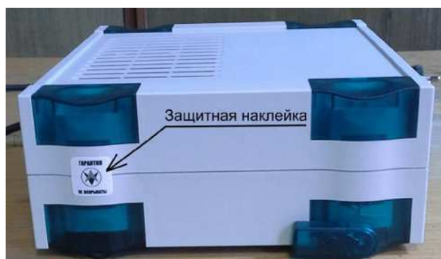
Рисунок 2 - Место нанесения защитной наклейки барометров образцовых переносных БОП-1М
