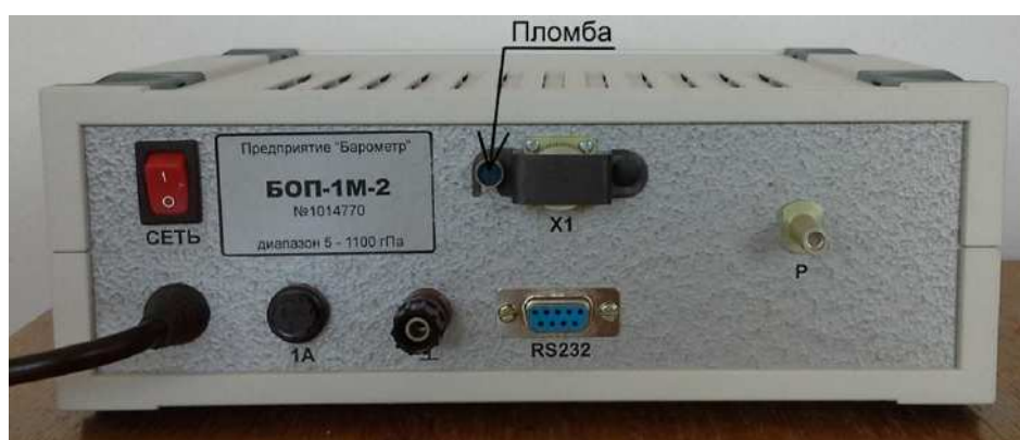
Рисунок 3 - Место пломбирования барометров образцовых переносных БОП-1М
