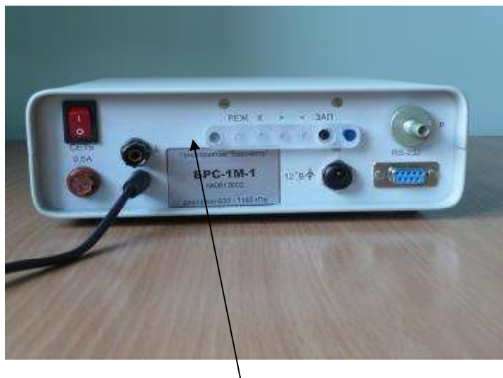
Рисунок 3 - Место нанесения пломбы на крышку кнопок коррекции барометра БРС-1М.
