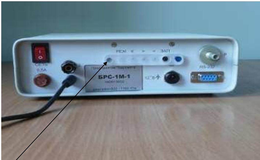
Рисунок 3 - Место нанесения пломбы на крышку кнопок коррекции барометра БРС-1М
