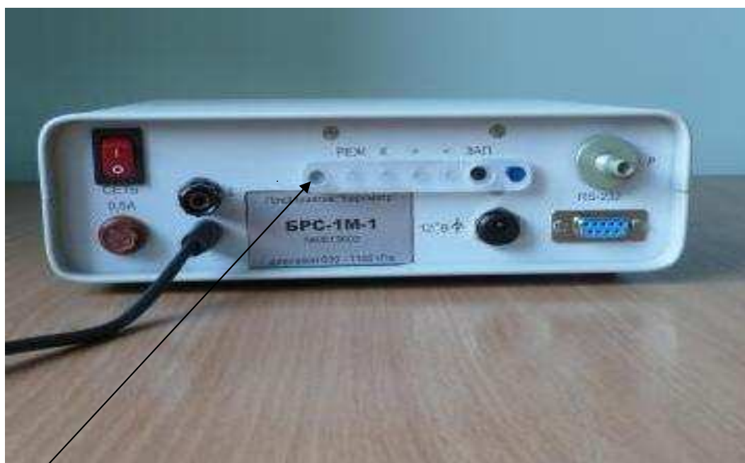
Рисунок 3 - Место нанесения пломбы на крышку кнопок коррекции барометра БРС-1М
